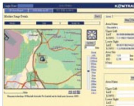
*Повышенный уровень безопасности – Функция «блокировка двигателя» позволяет задавать момент запуска двигателя машины. А используя функцию «область наблюдения», система Komtrax посылает уведомления каждый раз, когда ваша машина с той или другой стороны пересекает предварительно заданные границы рабочей зоны.*
