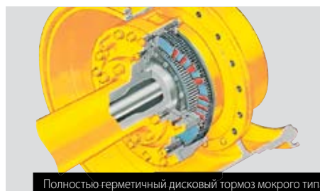
Полностью герметичный дисковый тормоз мокрого типа
