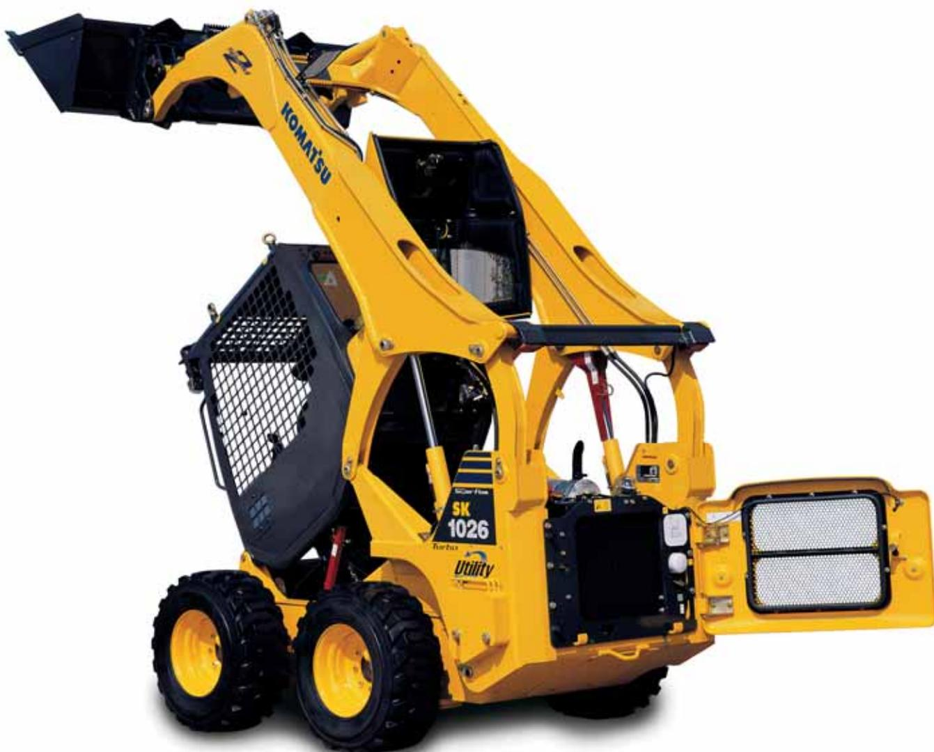
Для выполнения ежедневных проверок и технического обслуживания достаточно просто открыть задний капот машины. Для доступа к радиаторам (которые выполнены наклоняемыми), например, с целью их чистки, предусмотрено дополнительное отверстие в задней крышке. Кроме того, при выполнении специальных операций технического обслуживания кабину можно откинуть, получив полный доступ к ходовой части и основным узлам гидравлической системы.
