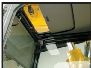
В крыше предусмотрено большое окно с интегрированным устройством затенения солнечного света
