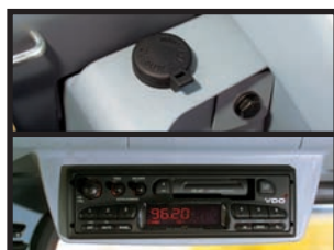
Гнездо для подключения электрических устройств с питающим напряжением 12 В, а также (по специальному заказу) кассетная радиомангитола
