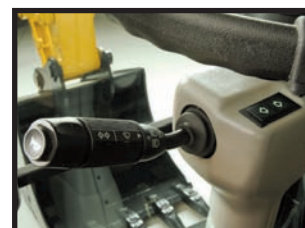
Наклоняемое multifunctionальное рулевое колесо с расположенными на нём органами управления стеклоочистителями, устройством подачи звукового сигнала и фарами, а также индикаторами.
