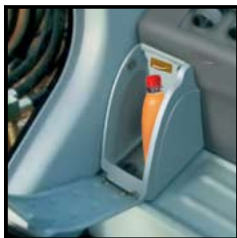
Камера подогрева и охлаждения
