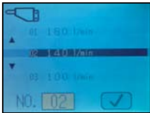
Экран грубой настройки расхода рабочей жидкости гидросистемы в режиме В (гидромолота)
