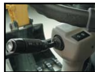
Рулевое колесо с регулируемым углом наклона, имеющее несколько функций; выключатель стеклоочистителя; индикатор звуковой сигнал и передние фары
