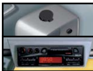
Блок питания напряжением 12 В и кассетная магнитола (устанавливаемая по заказу)
