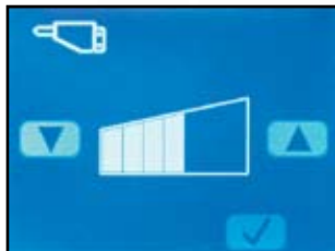
Экран точной настройки расхода рабочей жидкости гидросистемы в режиме В (гидромолота)
