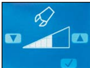
Экран точной настройки расхода рабочей жидкости гидросистемы в режиме Р (повышенной мощности) или Е (экономичном режиме)
