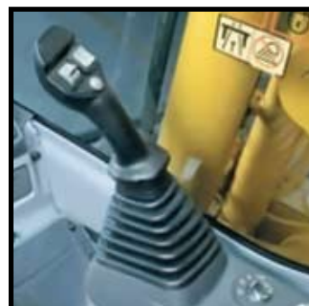
Рычаги типа "джойстик" с кнопочными переключателями пропорционального управления дополнительными рабочими органами
