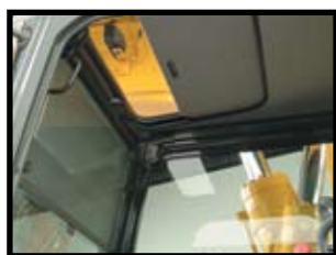
Большой прозрачный люк в крыше со встроенной свето-защитной шторкой
