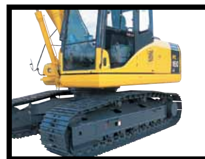
Гусеницы с заполненными консистентной смазкой герметичными шарнирами обеспечивают отличную долговечность ходовой части
