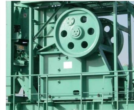
Щековые дробилки дробят камни постоянным дробящим движением по принципу эксцентрика. Вращение вала-эксцентрика и работа механизма подвижной распорной плиты создают высокое давление между двумя дробящими плитами. Вторая неподвижная плита установлена углом к подвижной. Таким образом в верхней части между плитами формируется широкое приемное окно. Порода, попадая между плитами, дробится в камере дробления и под действием силы тяжести проваливается вниз.
