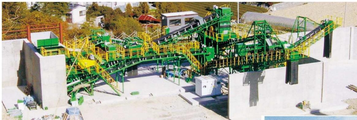
Модульный завод роликового типа
