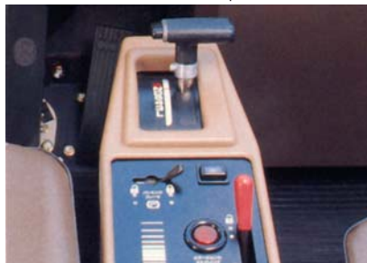
Система K-ATOMiCS (модернизированная коробка передач Комatsu с системой оптимального управления модуляцией)
