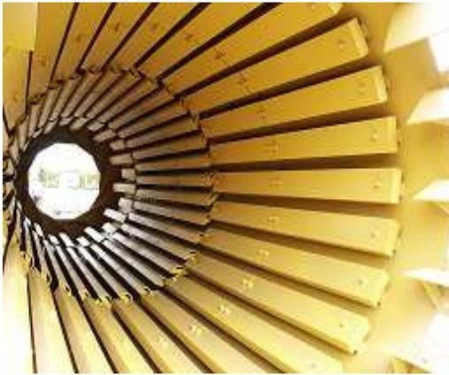
Конструкция сушильного барабана продумана так, что пламя горелки с макс. температурой горения в 1700 градусов эффективно передает тепло инертному материалу и нагревает его до 168 градусов, а выхлопной газ до 110 градусов. При этом внешняя (наружная) поверхность барабана не нагревается более 150-200 градусов.
