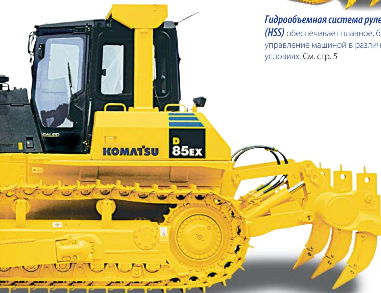
**Ходовая часть с низким приводом хода и длинной гусеничной лентой** обеспечивает исключительно высокую способность машины преодолевать подъемы и высокую устойчивость.
