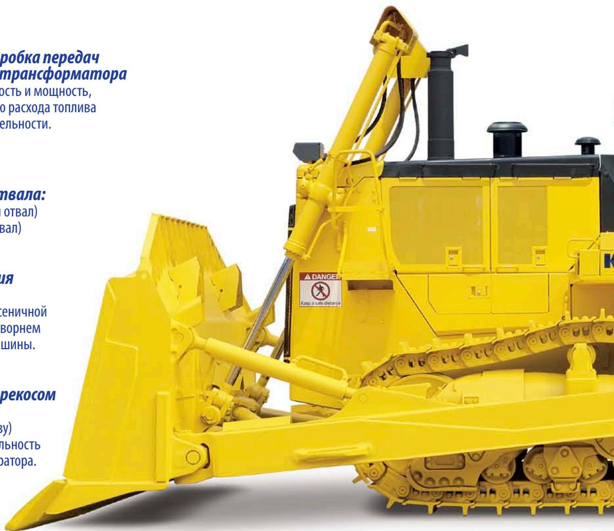
**Ходовая часть с низким центром тяжести,** длинными гусеницами и семью опорными катками обеспечивает устойчивость и великолепные возможности по преодолению подъемов.
