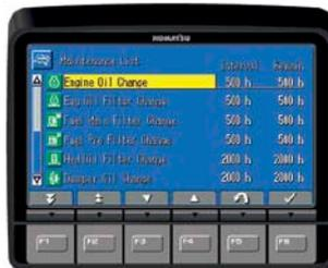
Экран перечня позиций технического обслуживания с указанием интервала между заменами
