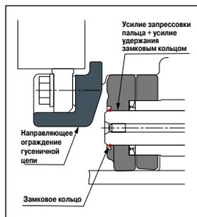
При этом облегчается техническое обслуживание звеньев и снижается повреждаемость пальцев при повороте пальцев и втулок. В результате увеличивается срок службы ходовой части и сокращаются расходы на техническое обслуживание за счет уменьшения износа, возможности повторного использования пальцев и уменьшения трудозатрат на техническое обслуживание.
